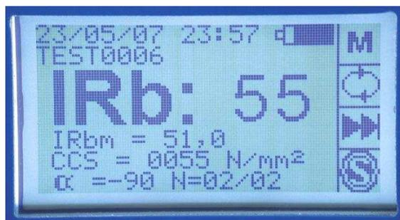
数显回弹仪可连接到高性能超声波检测仪
